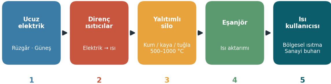
Şekil 1. Kum bataryasının şematik çalışma zinciri: ucuz elektrik ısıya çevrilir, yalıtımlı silodaki katı ortamda depolanır ve eşanjörle bölgesel ısıtmaya veya sanayi buharına aktarılır.
